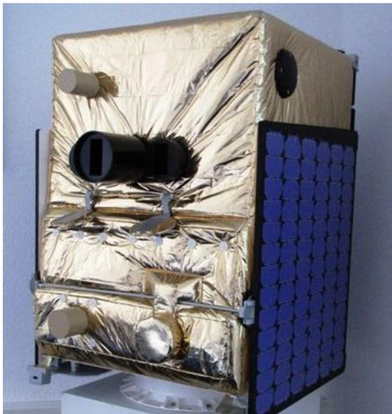
Ein Modell des Satelliten TET-1 im Maßstab 1:1. Seitlich anliegend die Sonnensegel, die im Orbit dann ausgeklappt werden. In der Mitte die Kamera.
